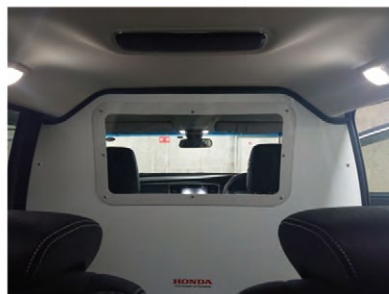
运送感染者的车辆内 (驾驶席和后座之间的隔板墙)
