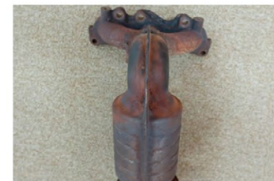
1999年产“Life”排气歧管的开裂
