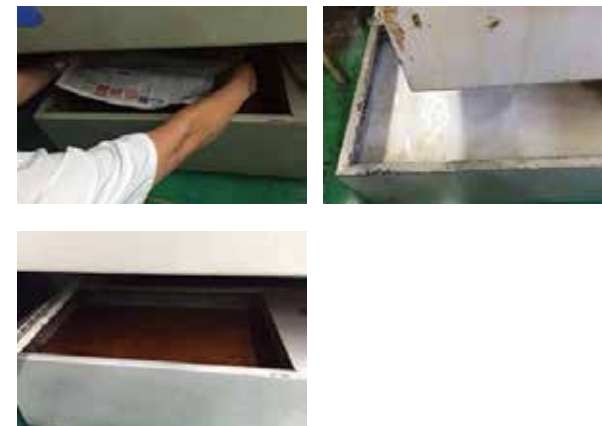
通过废旧报纸吸附切削液表面油脂保持切削液活性的过程
