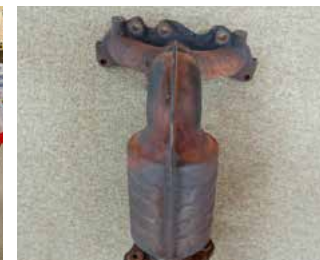
1999年产“Life”排气歧管的开裂
