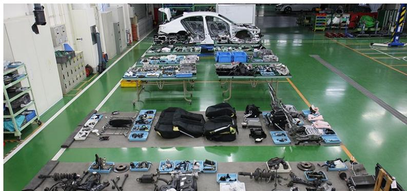
耐久性测试后的零部件检验
