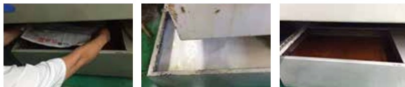
通过废旧报纸吸附切削液表面油脂保持切削液活性的过程
