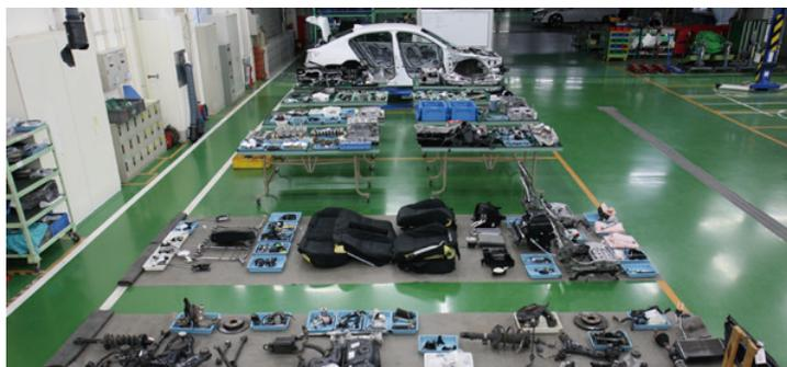
耐久性试验结束后对零部件进行检验
